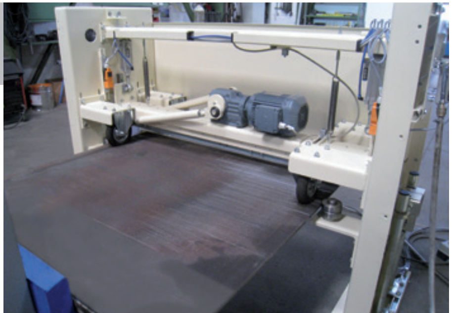
Härtebodenreinigung Очистка пода для затвердевания
