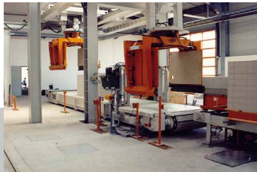
Speicherplattenband mit Manipulatoren Storing Slat Conveyor with Manipulators
